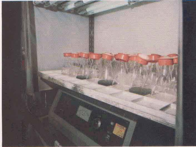
図2-3 500 ml 三角フラスコ(シリコン栓使用)による回転式振とう培養
